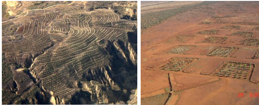
Fig.2 (左) 中国黄土高原における「魚鱗坑」と呼ばれる流出水捕集法。魚鱗の様な小穴を並べる。(右) 西オーストラリアにおける炭素固定のための植林用に作成した大規模捕集法
