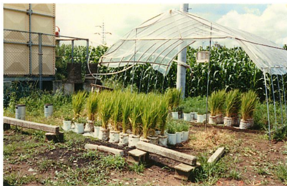
トレーサ試験地（茂原農業高校） 大気から水稻地上部へ直接沈着するヨウ素量 に及ぼす降雨の影響をみる
