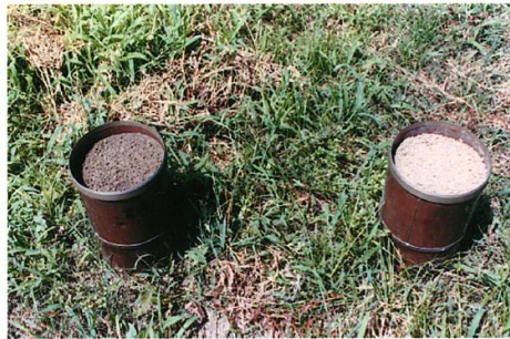
大気から土壌表面へ降下したヨウ素 の下層への浸透実験
