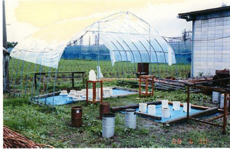
トレーサ試験地（茂原ヨウ素工場隣接地） 降雨の影響に注目（ビニール屋根の内と外）
