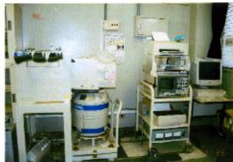
ゲルマニウム検出器・ガンマスベクトロメトリーシステム (アイソトープポット試験棟内)
